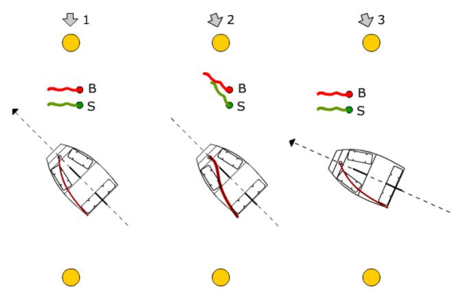
**Instante 1**: El viento tiene la dirección paralela a la línea que une las boyas. El timonel, con la vela correctamente cazada y el rumbo adecuado (a 45° del viento) ve que sus dos lanitas están horizontales.
