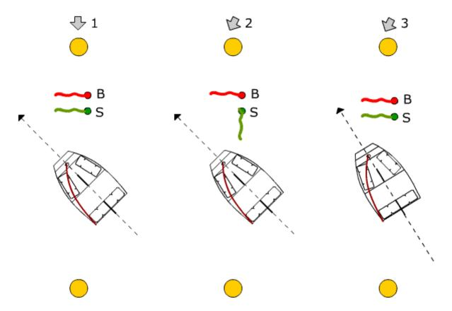
**Instante 1**: El viento tiene la dirección paralela a la línea que une las boyas. El timonel, con la vela correctamente cazada y el rumbo adecuado (a 45° del viento) ve que sus dos lanitas están horizontales.
