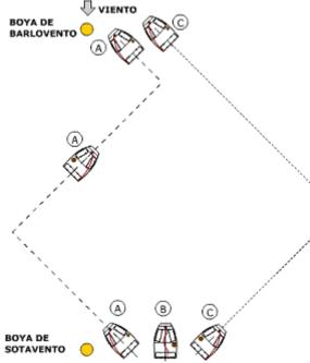
**NAVEGACIÓN EN POPA REDONDA:** El viento entra justo por la popa del bote, paralelamente a la línea de crujía. La vela puede estar en cualquiera de los dos lados, por eso en el gráfico hay una vela dibujada con líneas de puntos. En este caso el viento no entra por ninguna de las bandas, pero igual se dice que está amurado a estribor o babor, según la posición de la vela. En el gráfico, si la vela está del lado de babor el bote está amurado a estribor y viceversa.
