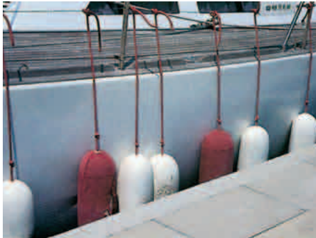
Las defensas cilíndricas son el tipo más difundido por su eficacia y el poco espacio que ocupan a bordo
