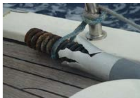
Fig 26 – Contra rígida de la botavara rota por corrosión no apreciable a simple vista desde el exterior. Edad del elemento: 8 años instalado a bordo. Fuente: Propia.
