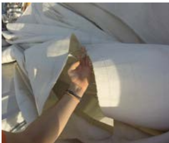
Fig. 12 – Reparación del spinnaker asimétrico con Dr. Sails tras una rotura de unos 20cm. Fuente: Propia.
