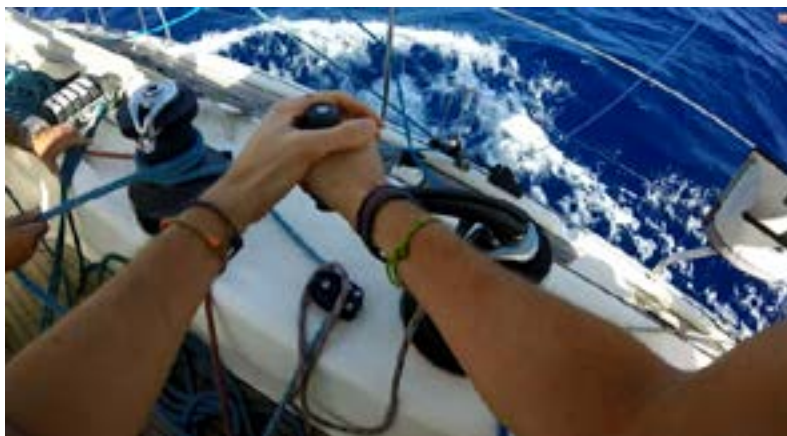
Fig. 17 – Cuando se enrolla el Génova deshaciendo la configuración de atangonado a barlovento es necesario llevarlo a winche debido a la carga que genera el viento aunque se lasque escota. Esta maniobra requiere resistencia y fuerza muscular en la zona de los brazos y espalda; la técnica y la posición también son factores a tener en cuenta.
