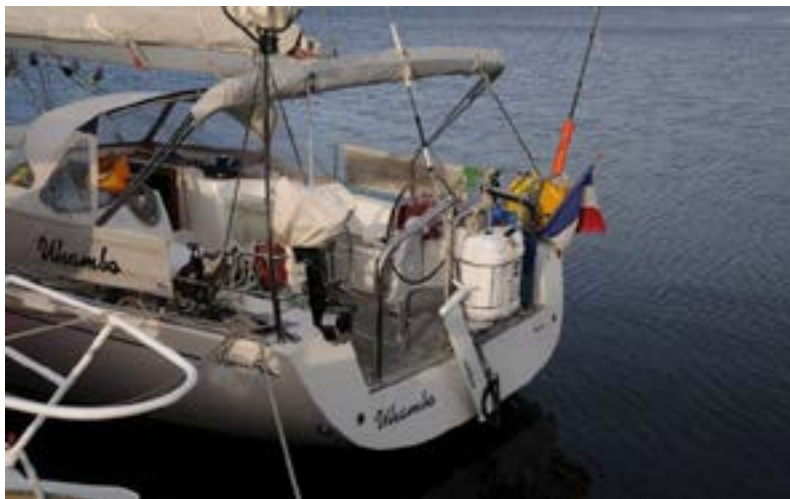
Fig. 15 – Velero de 43 pies de eslora preparado oceánicamente con un hidrogenerador de la casa Watt&Sea. En la foto se muestra con el mecanismo retraído, no en su posición de carga, que estaría sumergiendo la pequeña hélice en el agua. Fuente: http://www.myhanse.com
