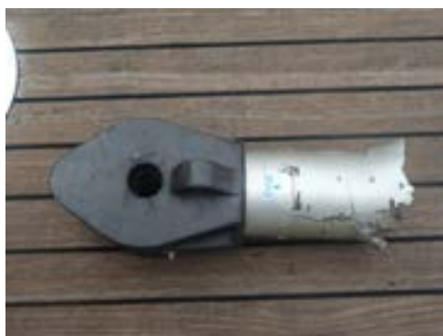
Fig 26 – Contra rígida de la botavara rota por corrosión no apreciable a simple vista desde el exterior. Edad del elemento: 8 años instalado a bordo. Fuente: Propia.
