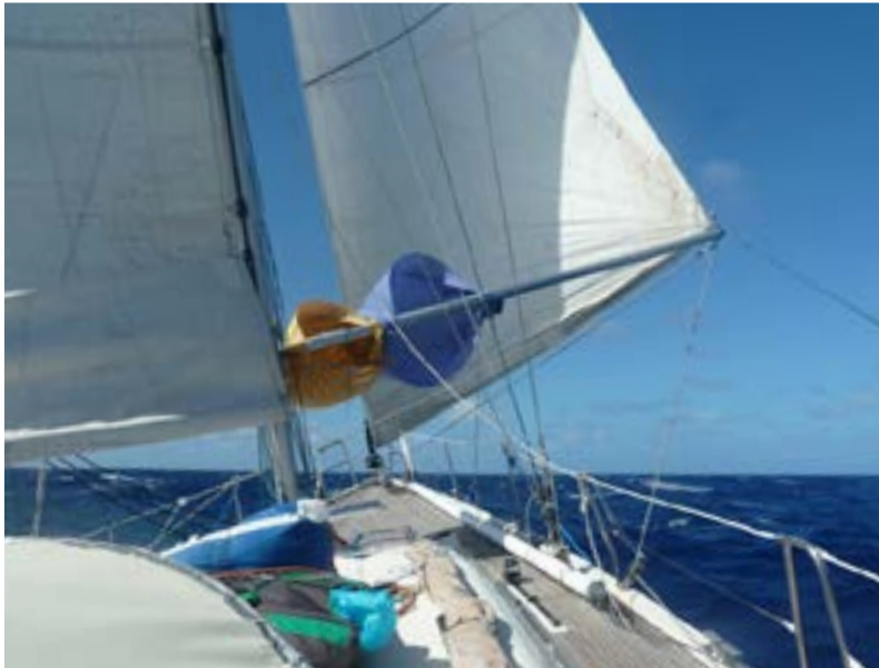
Fig 9 – Configuración de navegación habitual para intensidades fuertes de viento y para navegación nocturna. Mayor con el primer rizo y el foque atangonado a barlovento, permite un ángulo al viento de navegación de hasta 120° de aparente. Las sábanas tendidas han sido víctimas de un roci6n por una escotilla abierta y se han aprovechado para ganar superficie vélica. Fuente: Propia.
