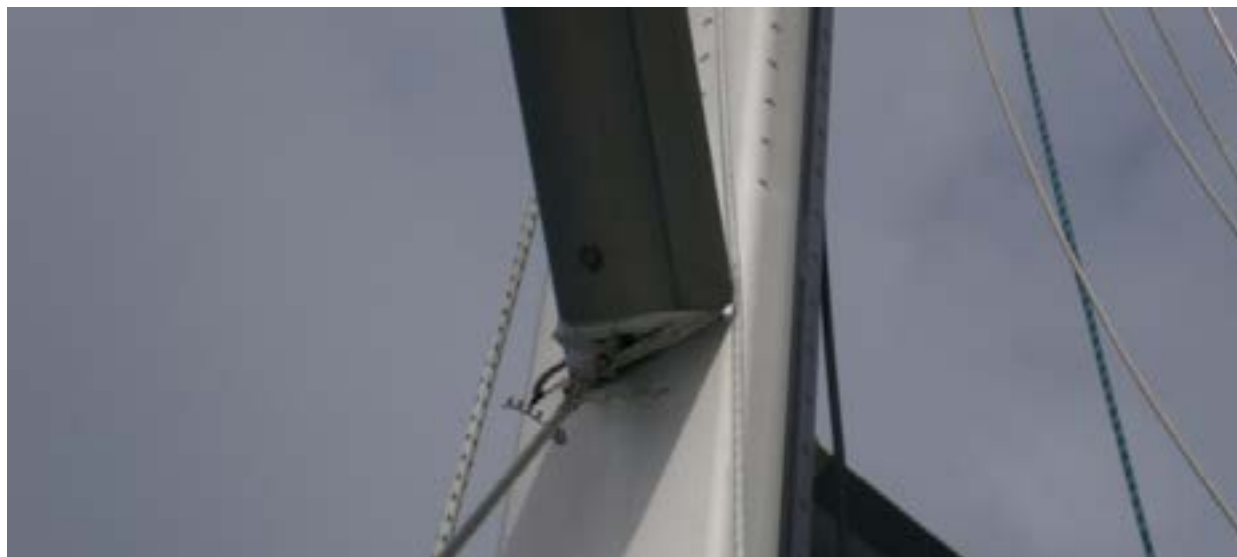
Fig 5. – Obenque bajo deshilándose a bordo del The Best Skipper durante el Gran Prix 2014. Fuente: Propia.
