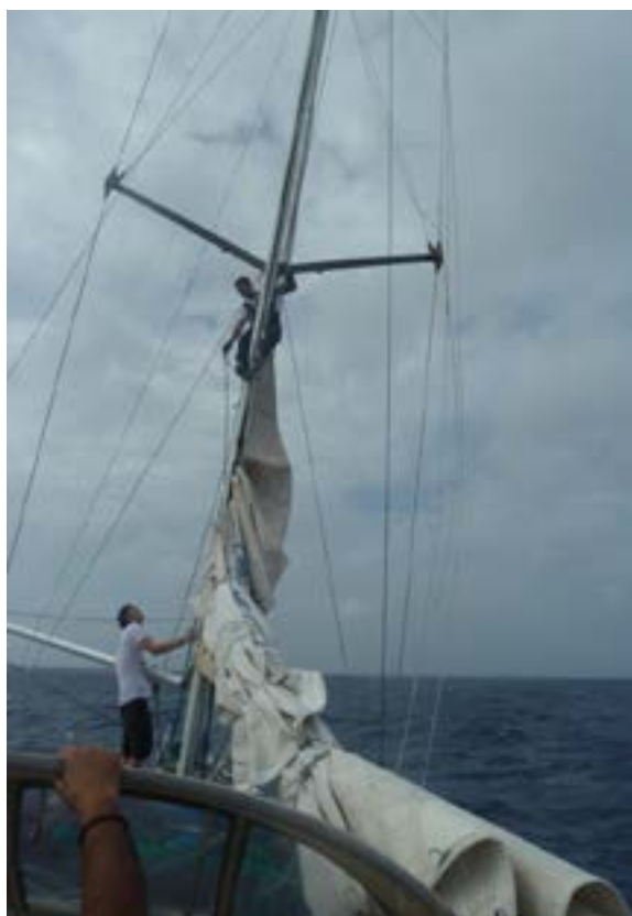
Fig. 25 – Refuerzo de la jarcia al observar roturas en hilos de los obenques bajos tras un temporal de 3 días. Obenques de fortuna a partir de una escota reenviados a winche con la tensión adecuada para prevenir la caída o rotura del mástil en caso de evolución del desgaste de los de los obenques. Fuente: Propia.
