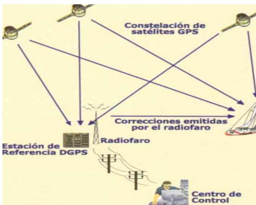
Esquema de funcionamiento de DGPS
